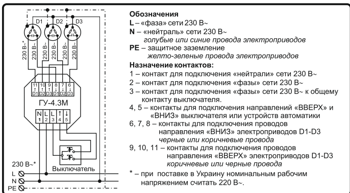
Рисунок 1 – Типовая схема подключения ГУ-4.3М
